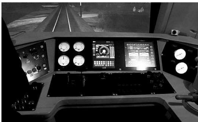
Рис. 1.1. Кабина-тренажер, используемая для мониторинга физиологических параметров у машиниста при полной имитации его работы с синхронизацией со временем — часами суток
