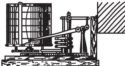
Рис. 5. Барограф. Коробочка с разреженным воздухом — в середине (трёхъярусная). Длинный указатель, закреплённый осью на стойке справа, чертит пером на своём левом конце по бумаге, натянутой на большем полубарабане, который вращается часовым механизмом (внутри его).
