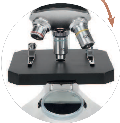
Объект должен лежать так, чтобы прямо через него проходил поток света от зеркала к объективу
