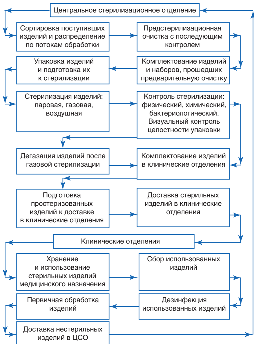
Рис. 1.1. Схема технологической цепочки дезинфекции и стерилизации изделий медицинского назначения в ЦСО
