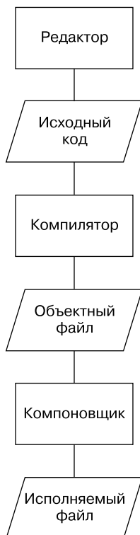
Рис. 1.1. Создание исполняемого файла на основе исходного кода C++
