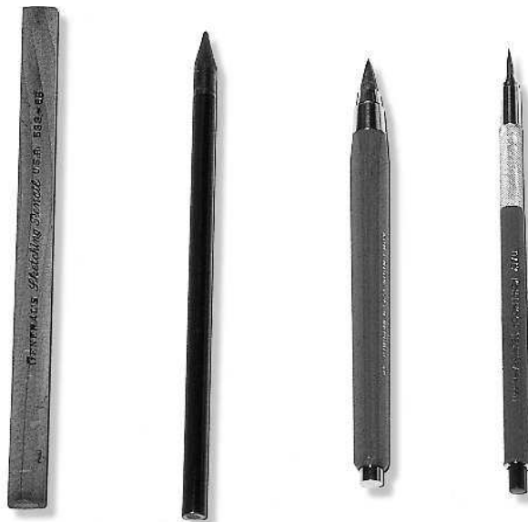
ВЫБОР КАРАНДАША Слева направо изображены карандаши: плотницкий, графитовый без деревянного корпуса, а также большой и маленький держатели для грифеля.
