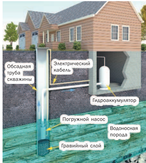
Водоснабжение от скважины
