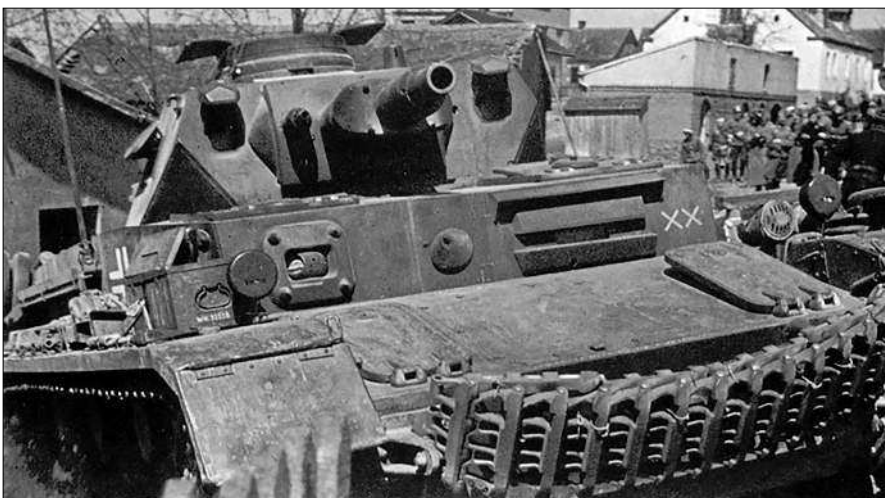
Танк Pz. IV 6-й танковой дивизии. Фрагмент гусеничной цепи давал дополнительную защиту машины.
