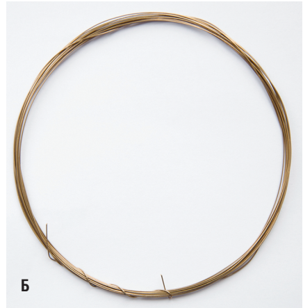
Рис. 1.6. Проволока: А — алюминиевая; Б — бронзо-алюминиевая (лигатурная)
