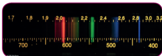
Рис. 2.6. Спектр компактной люминесцентной лампы с сильными эмиссионными линиями ртути (изображение предоставлено Робом Брауном)
