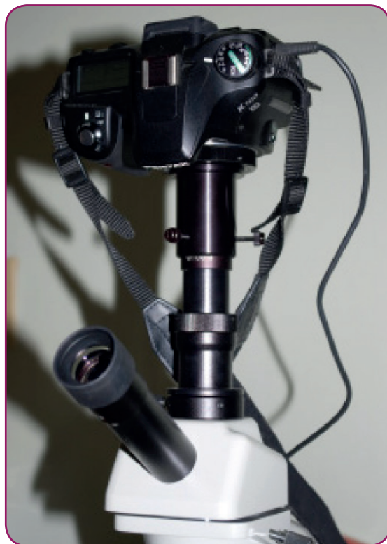
Рис. 2.5. Цифровой зеркальный фотоаппарат, закрепленный на микроскопе с помощью T-кольца и специального адаптера
