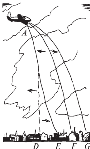
Рис. 3. Путь, по которому падают бомбы, сброшенные с аэроплана: AF — в безветренную погоду; AG — при попутном ветре; AD — при встречном ветре; AE — при ветре, встречном вверху и попутном внизу
