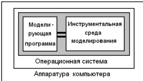
Рис. 1.1. Составляющие компьютерной модели
