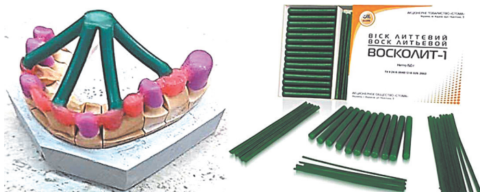
Рис. 5.19. Воск литейной «Восколит-1» и его использование для построения литниковой системы
