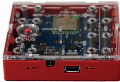
Рис. 1.12. Разъем для подключения блока питания и разъем мини-USB
