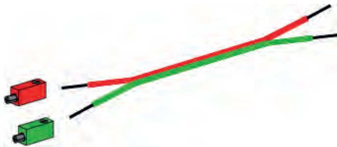
Рис. 1.8. Двухжильный провод и штекеры
