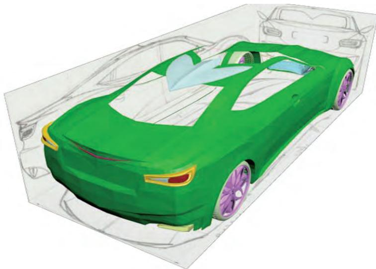
**Рис. 1.13.** Построение трехмерной модели кузова на основе эскизов
