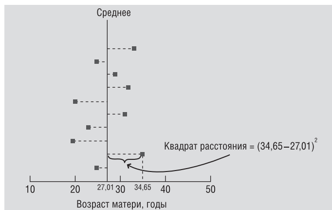
Рис. 6.2. Диаграмма показывает рассеяние выбранных значений возраста матери во время рождения ребенка (глава 2) вокруг средней величины. Вариация вычисляется путем суммирования разностей от каждой точки до среднего значения, возведенных в квадрат, и делением этой суммы на (n-1)
