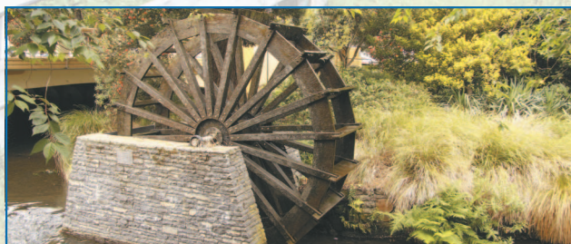
Водяное колесо с нижней подачей воды.
