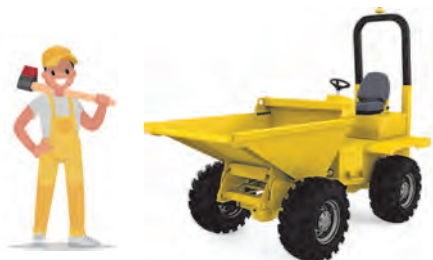
Микросамосвал грузоподъемностью до 600 кг
