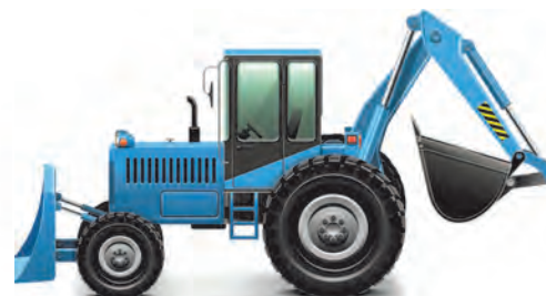
Трактор с навесным оборудованием: экскаваторным ковшом и бульдозерным «отвалом».
