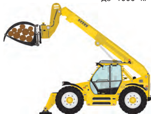
Лёгкий манипулятор может поднять груз до 7 тонн на высоту 9 метров.
