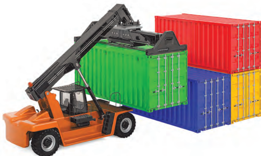
Тяжёлые телескопические погрузчики «ричстакеры» поднимают груз до 50 тонн и на высоту 15 метров.
