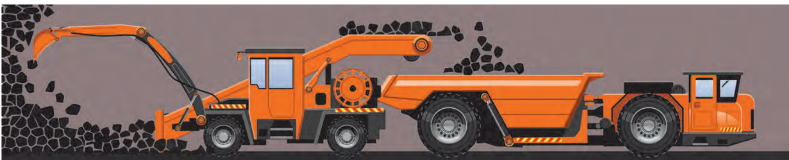
Проходческий комбайн экскаваторного типа загружает низкопрофильный самосвал. Такой комбайн используется при разработке мягкой породы.
