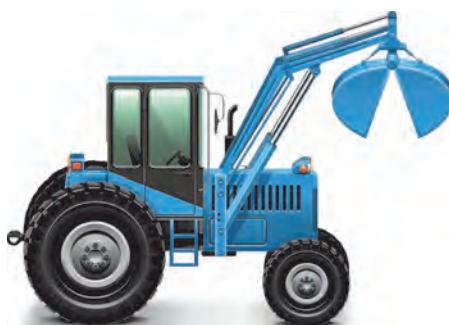
Колёсный погрузчик экскаваторного типа грузоподъёмностью до 800 кг
