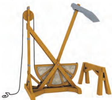
Модель устройства для углубления дна каналов по чертежам Леонардо да Винчи
