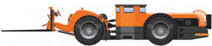
Подъёмник для перевозки грузов и оборудования под землёй
