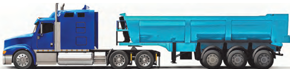
Седелный тягач с полуприцепом-самосвалом грузоподъемностью 55 тонн
