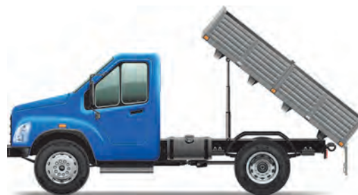
Мини-самосвал с низкой грузоподъемностью — до 2 тонн
