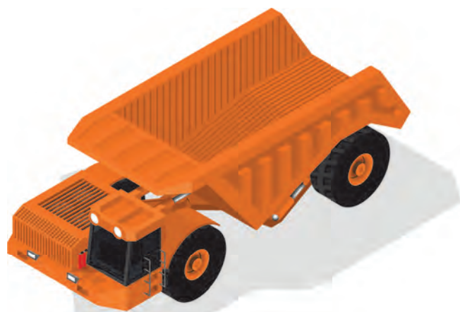
Низкопрофильный самосвал для работы под землёй
