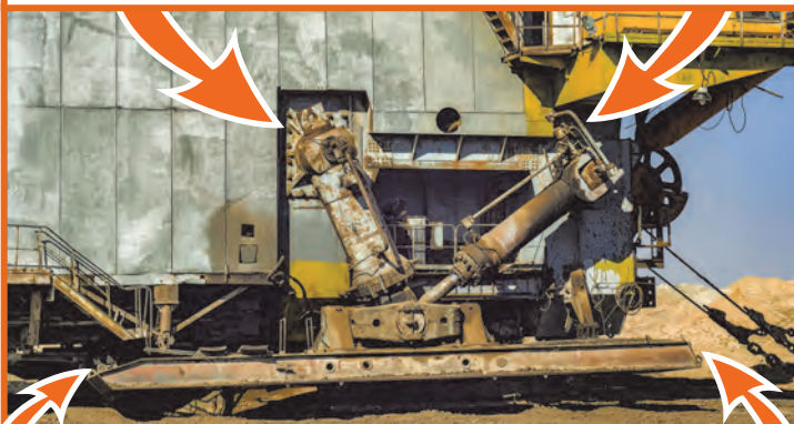
Опорные башмаки в поднятом состоянии
