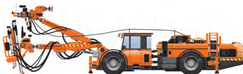
Машина для крепления и прокладки электрических кабелей в тоннелях
