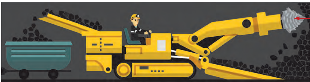
Проходческий комбайн лучевого типа с резовыми коническими коронками
