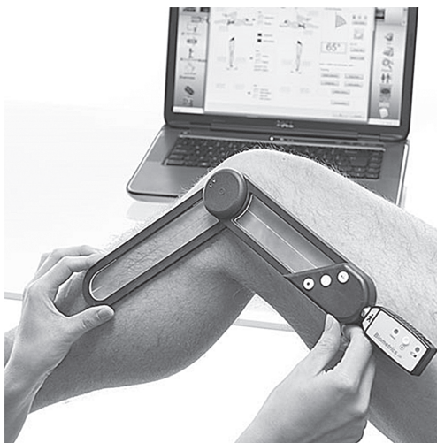
Рис. 10.4. Измерение объема движения в коленном суставе с помощью цифрового гониометра
