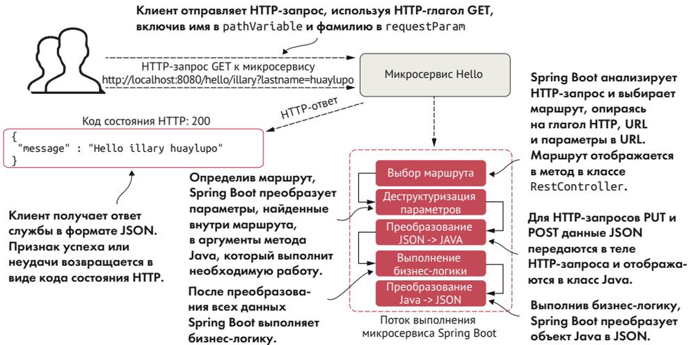
**Рис. 1.5.** Spring Boot абстрагирует общие задачи микросервиса REST (маршрутизация к бизнес-логике, синтаксический анализ параметров в URL, преобразование JSON в объекты Java и обратно) и позволяет разработчику сосредоточиться на бизнес-логике службы. На этом рисунке показаны три разных способа передачи параметров нашему контроллеру
