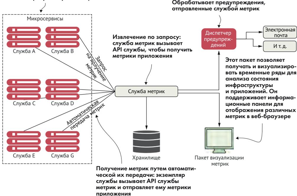
**Рис. 1.16.** Метрики извлекаются из микросервисов или передаются ими автоматически, собираются и хранятся в службе метрик, откуда потом они могут быть получены пакетом визуализации и инструментами управления предупреждениями
