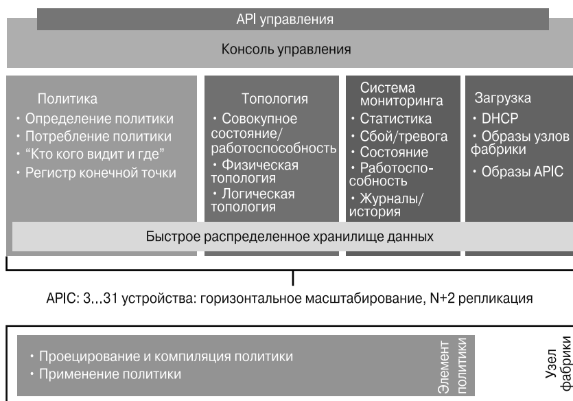
Рис. 3.30. Структура контроллера Cisco APIC
