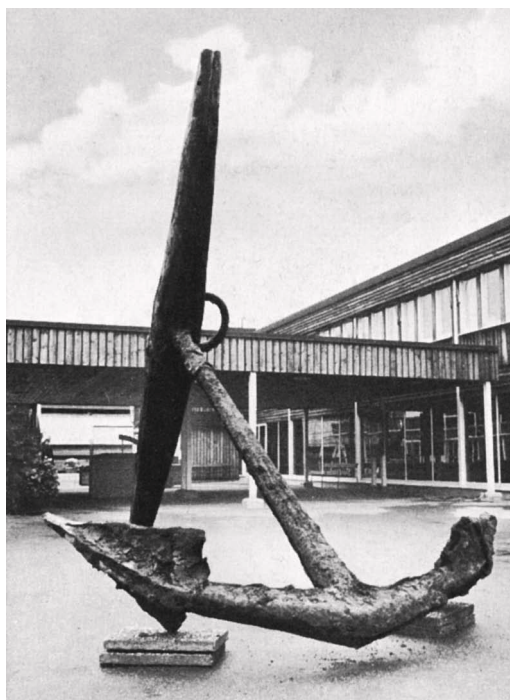
■ Один из якорей «Вазы», который вчерне был изготовлен в регионе Бергслаген, а потом прошел окончательную обработку в кузнице на Скеппхольмене
