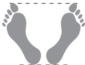
Стоящий человек не падает только до тех пор, пока отвесная линия из центра тяжести находится внутри площадки, ограниченной краями его ступней (см. рисунок вверху). Поэтому так трудно стоять на одной ноге; еще труднее стоять на канате: основание очень мало и отвесная линия легко может выйти за его пределы.
