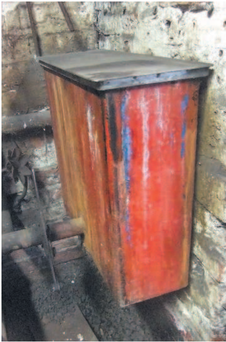
Бак с водой на задней стенке горна с клапаном, регулирующим подачу воздуха.
