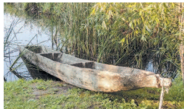
Челн-однодревка. У всех славянских народов на протяжении веков челны-однодревки строились одинаково и отличались разнообразием форм, которые были абсолютно нерациональными с точки зрения гидродинамики
