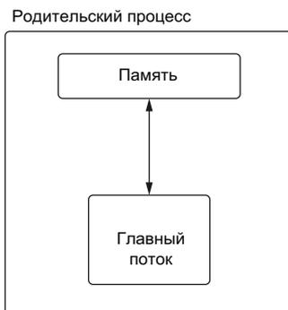
**Рис. 1.3** Процесс с одним главным потоком, читающим данные из памяти
