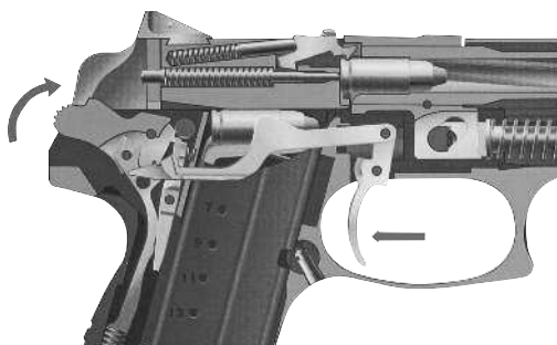
Положение частей пистолета «Грач» перед выстрелом
