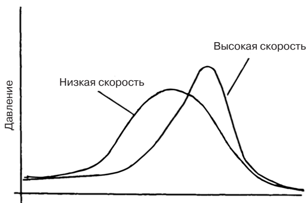
Рис. 10. Тепловая десорбция простого загрязнения на поверхности при двух скоростях нагревания. Быстрота откачки также может влиять на кривые десорбции
