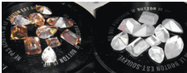
Рис. 2. Обесцвечивание алмазов путем термобарической обработки
