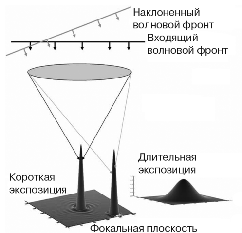
Рис. 1.1. При короткой экспозиции в результате наклона волнового фронта смещается точка фокусировки излучения в фокальной плоскости. При длительной экспозиции профиль интенсивности расплывается
