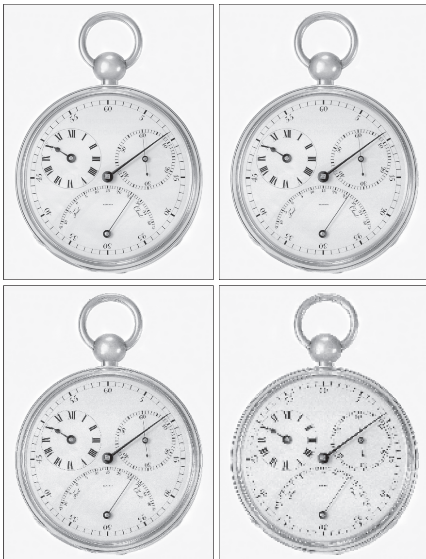
Рис. 2.20. Типичные эффекты при уменьшении пространственного разрешения. Приведены изображения с разрешением (а) 1250 dpi, (б) 300 dpi, (в) 150 dpi и (г) 72 dpi. Тонкие рамки добавлены для удобства, они не являются частью изображений
