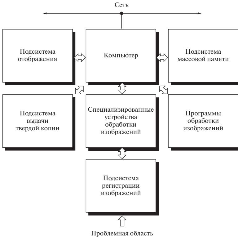
Рис. 1.24. Компоненты универсальной системы обработки изображений
