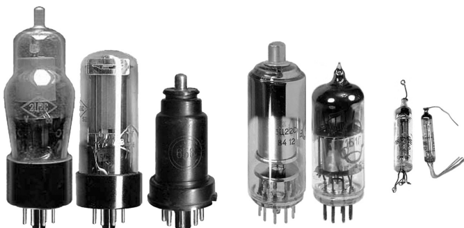
Рис. 3.7. Конструкции электронных ламп
