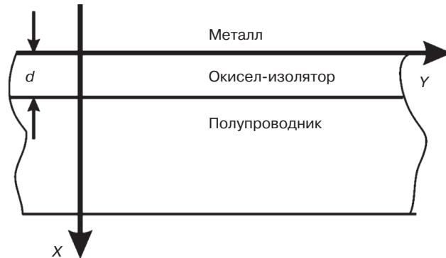
Рис. 1.1. Эскиз типовой МОП-структуры
