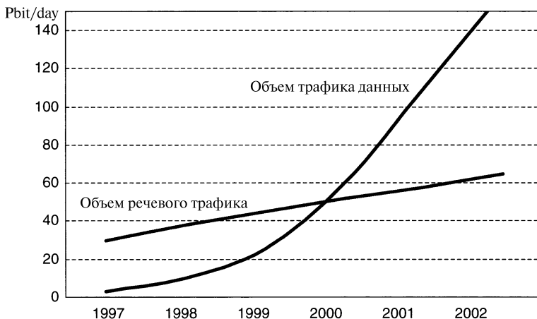
Рис 1.8. Изменение характера трафика телекоммуникационных сетей от речевого к трафику данных.
