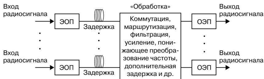
Рис. 1.1. Обобщенная функциональная схема многоканальной ВОСП
