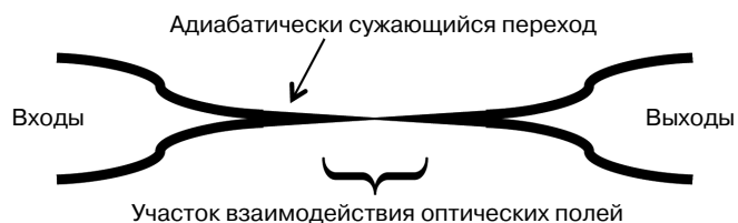
Рис. 1.14. Схематическое изображение волоконно-оптического ответвителя типа 2 \times 2 на базе сплавного сужающегося перехода
