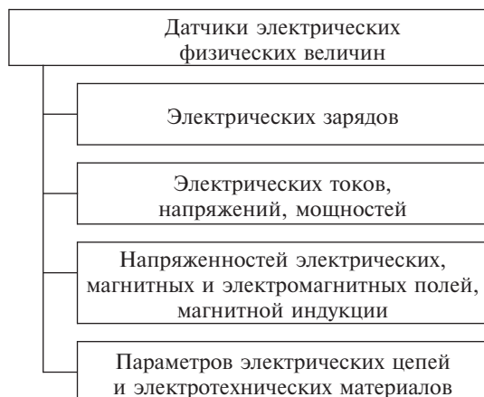
Рис. 1.6. Классификация датчиков по виду измеряемых электрических величин
