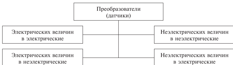
Рис. 1.3. Классификация преобразователей по виду входных и выходных величин
