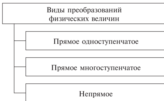
Рис. 1.7. Классификация видов преобразования физических величин
