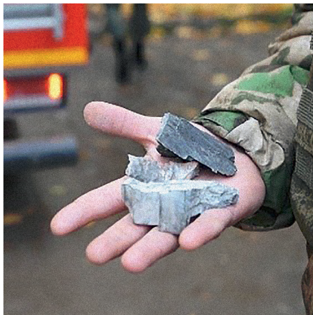
Рис. 1.1. Осколки естественно-дробимого корпуса разорвавшегося традиционного снаряда
