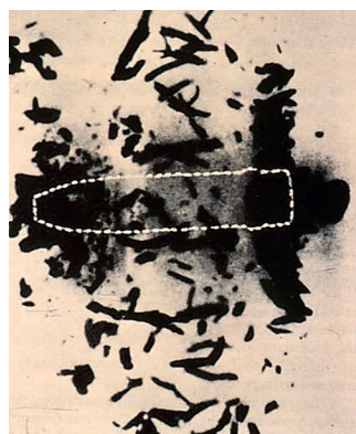
Рис. 1.6. Образование осколков при разрыве осколочной гранаты
