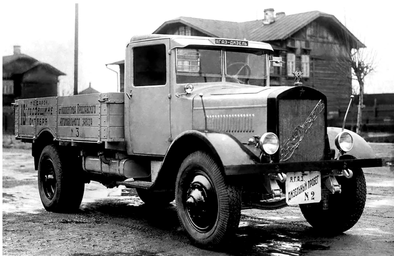
Грузовик Я-5 с дизельным двигателем «Коджу», подготовленный для второго международного «дизельного» пробега. 1934 год (РГАКФД).
